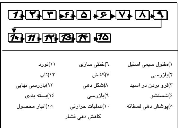
۶- سیمهای آنیل شده بر اساس نوع سفارش و قطر طناب توسط دستگاه راپینگ ( طناب کننده ) دور رشته مغزی پیچیده می شوند و طناب فولادی را بوجود می آورند
